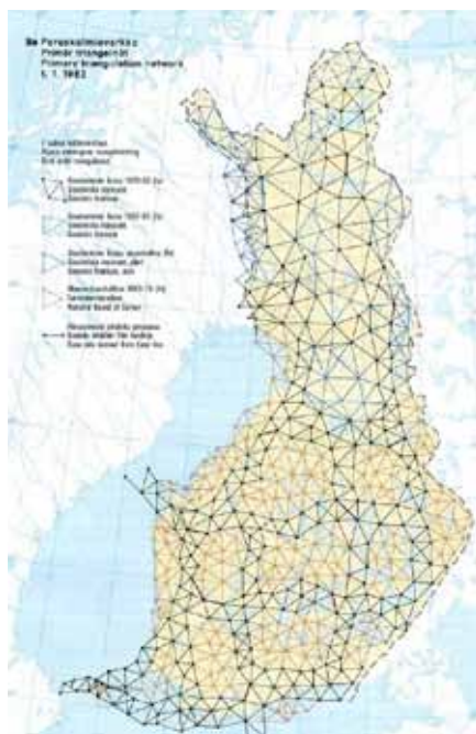
Suomen I-luokan kolmioverkko (alhaalla). Geodeettisen laitoksen mittaama verkko on mustalla, Maanmittauslaitoksen Ib-luokan verkko punaisella. Ylhäällä ovat Geodeettisen laitoksen ja Maanmittauslaitoksen mittaamat I- ja II-luokan GNSS-pisteet.
