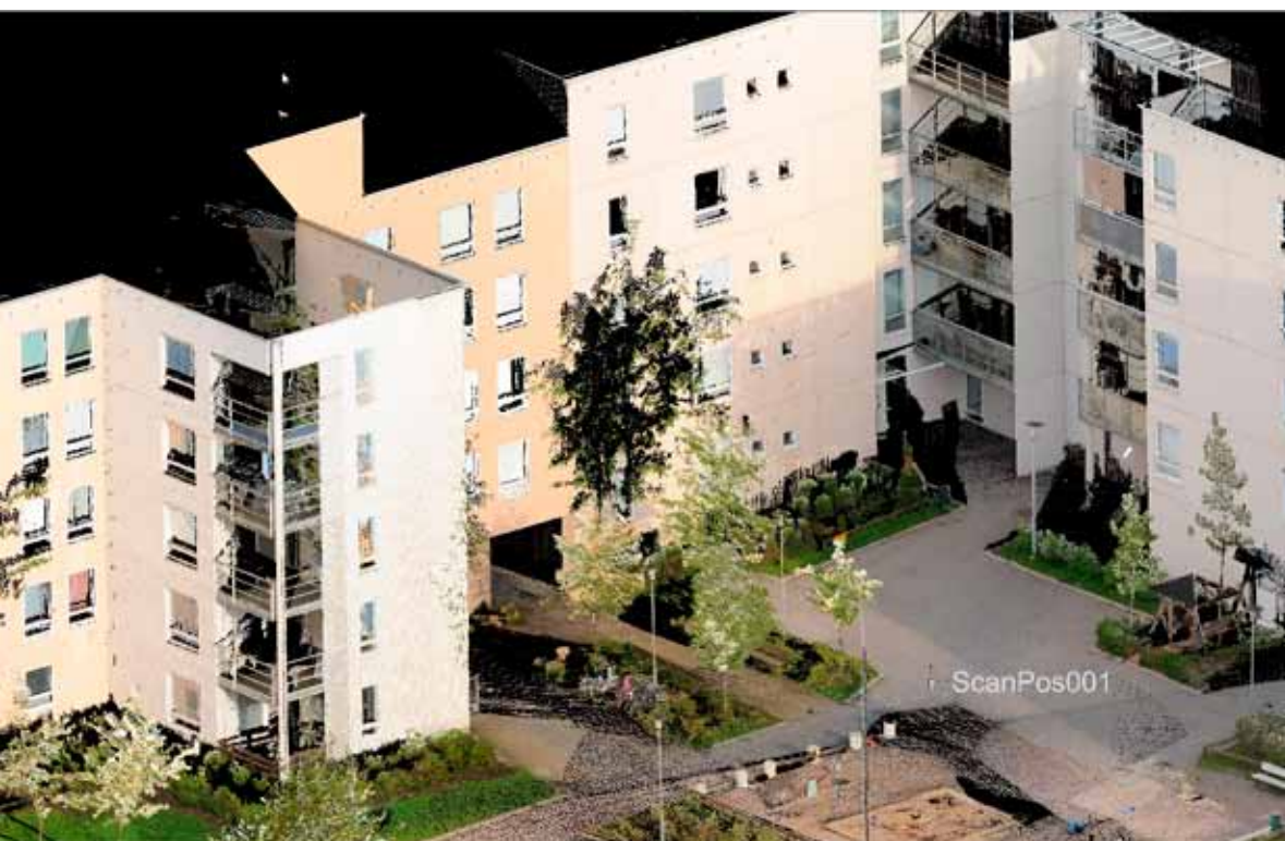
Laserskannauksella mitattua asuin ympäristöä Vuosaaren Kallahdessa. Kuvassa näkyvien 3D-mittapisteiden väriarvot on laskettu valokuvista.
