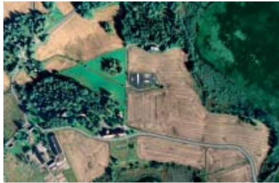
Kuva 3. Z/I Imaging DMC -kameralla syyskuussa 2005 kuvattu kuva, kuvan keskellä Sjökillan kalibrointikenttä. Kuvauskorkeus 800 m.
