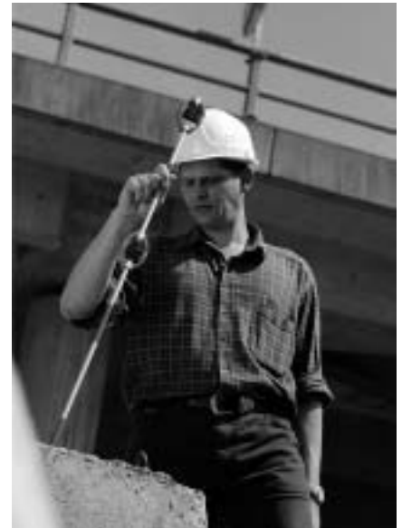
Mittaustyötä voidaan ohjata myös prisman päästä.
