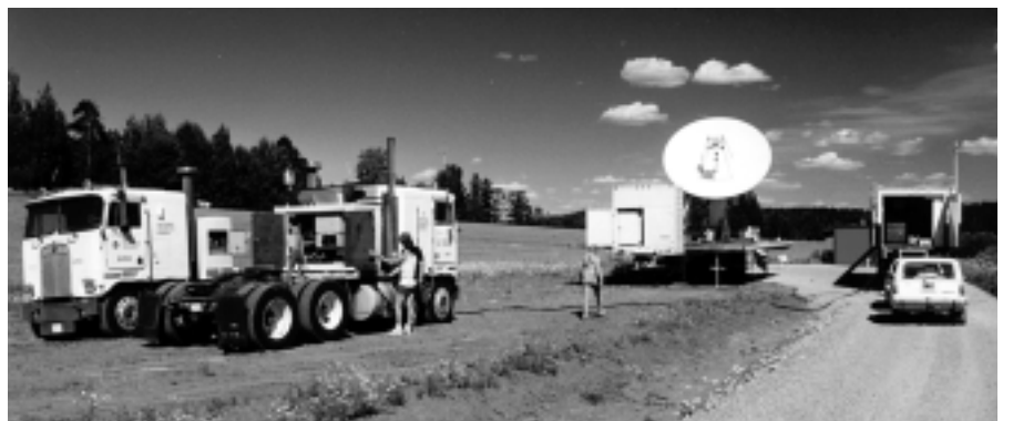
EUREF-järjestelmän ensimmäiset perustavat mittaukset. Siirrettävä VLBI-laitteisto Metsähovin Sjökillan pisteellä v. 1988. Kuva M. Poutanen / Geodeettinen laitos.
