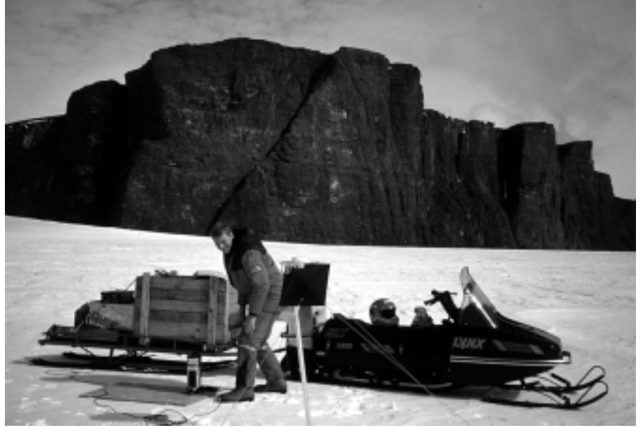
Painovoimamittausta Etelämantereella. Kuva M. Ollikainen / Geodeettinen laitos.
