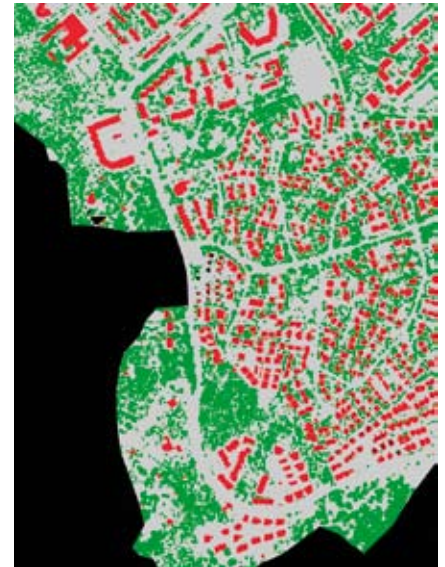
Automaattisesti tunnistetut rakennukset, puusto ja maanpinta Laurinlahdessa.
