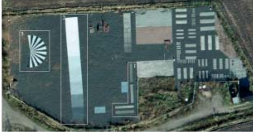
KUVA 1. Sjököllan testikenttä. Tutkimuksessa käytetyt testikuviot: 1) viivaparit erotuskyvyn mittaamiseen 2) harmaasävykiila 3) Siemens-tähtikuvio.
