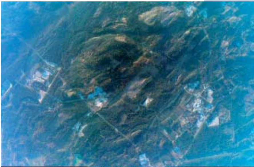
KUVA 2. Korkealta heikoissa valaistusolosuhteissa otettu UltraCamD-kuva. Kuvan reunoilla näkyy suuria ongelmia erityisesti sinisellä aallonpituudella. Vastaava ilmiö näkyy heikompana myös paremmissa valaistusolosuhteissa. Tämä johtunee kamerassa käytetystä optiikka/suodinyhdistelmästä, jota on sittemmin parannettu.
