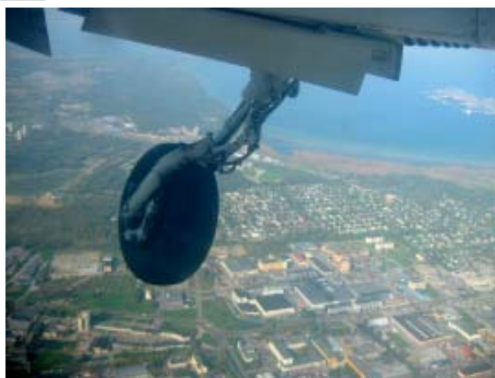
KUVA 8. ADS40- ja DMC-kameratesteissä jouduttiin ottamaan laskutelineet ulos, jotta pystyttiin lentämään tarpeeksi hitaasti. Kamerrat vaativat hidasta lentonopeutta, jotta saadaan aikaiseksi riittävän pitkä valotusaika.
