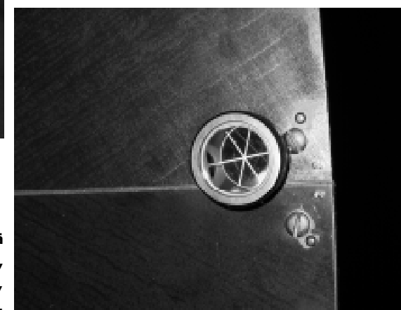
Robottitakymetri, kierrettävä ja pyöritettävä kehystaalu, johon prisma on kiinnitetty, sekä miniprisma.
