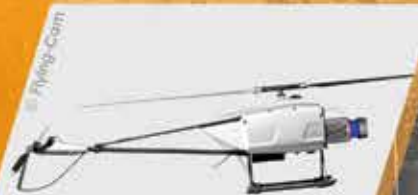
VUX®-1 asennettuna lennokkiin, esim. Flying-Cam 3.0 SARAH
