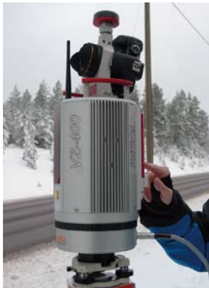
Kuva 6. Riegl VZ-400 on uusimpia kaupallisia laitteita, joka vaikuttaa siirtävän pulssilaserit suorituskyvyltään aivan uuteen luokkaan sekä nopeudellaan että tarkkuudellaan.
