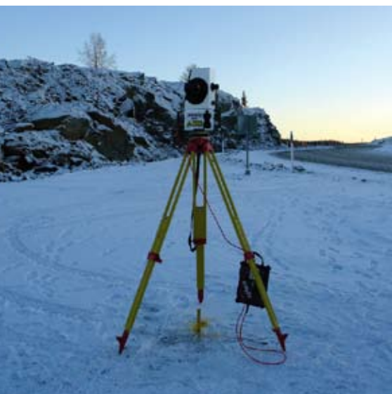
Kuva 8. I-Site 4400 LR -keilain Talvivaarassa. Australialaista laitetta on testattu Etelänapamantereella –40 asteen pakkasissa ja siinä on etäisyysmittauksen kanssa samanaikaisesti toimiva pyörivä 37 megapikselin viivakamera.
