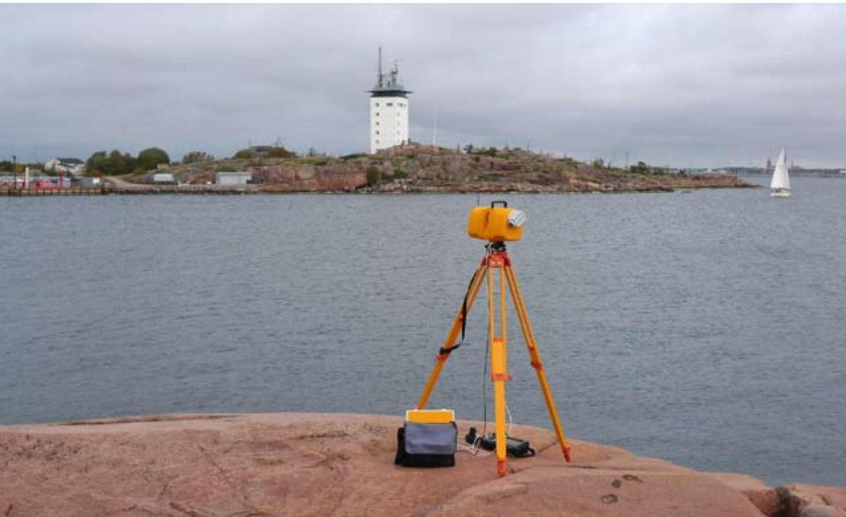
Kuva 11. Callidus CPW8000 -hybridikeilain skannaamassa kalliopiiirroksia Hangon Hauensuoella. Laitteen mittauseriaatteessa yhdistetään pulssi- ja vaihe-errotekniikoita, jotta vaihe-erokeilaimille tyypillinen etäisyysmittauksen nopea heikkeneminen matkan funktiona saataisiin kuriin.
