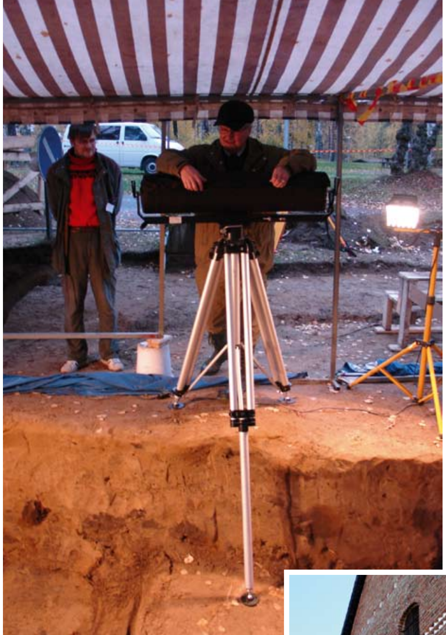
Kuva 3. Lappeenrannan Huhtiniemessä oikeusarkeologisissa tutkimuksissa keilattiin muun muassa Mensi 25 -keilaimella. Kuvassa Mika Lavento ja Hannu Heinonen. Tällä jo myynnistä poistuneella skannerilla saa mitattua pienikohinaista pistepilveä 2–25 metrin etäisyysalueella.
