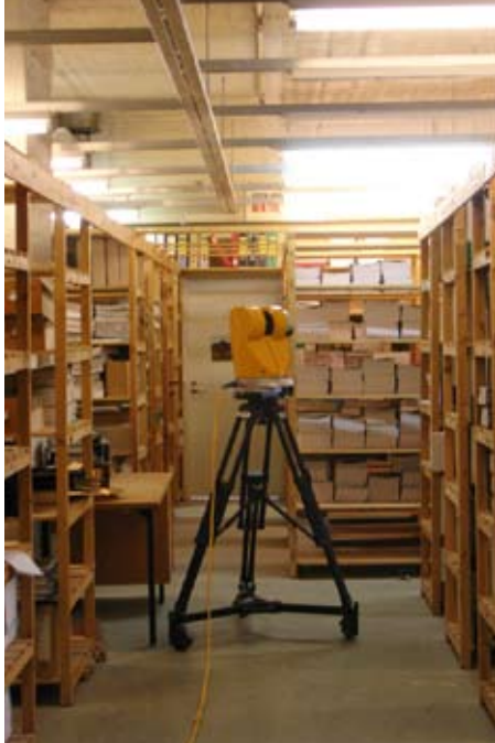
Kuva 5. Eräs varhaisimpia kaupallisia skannereita, Callidus CP3200, mittaamassa arkistohuonetta. Tämä laite on markkinoiden varhaisimpia ympäripyöriviä pulssilaserkeilaimia, mutta sen nopeasti levenevä lasersäde ei sovellu pienten yksityiskoh- tien tallentamiseen.
