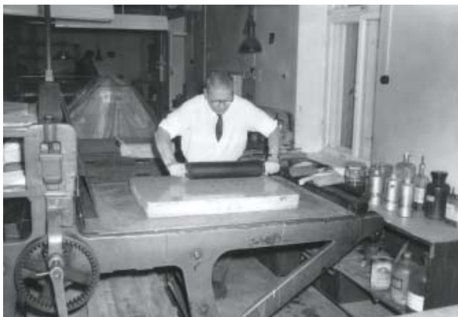
Maanmittaushallituksen Kivipainon käsipainokone. Painokivelle väreä levittämässä Lauri Koivunen.
