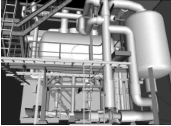
Kuva2. Laserkeilaus tuottaa tarkan 3D-mallin kohteesta.
