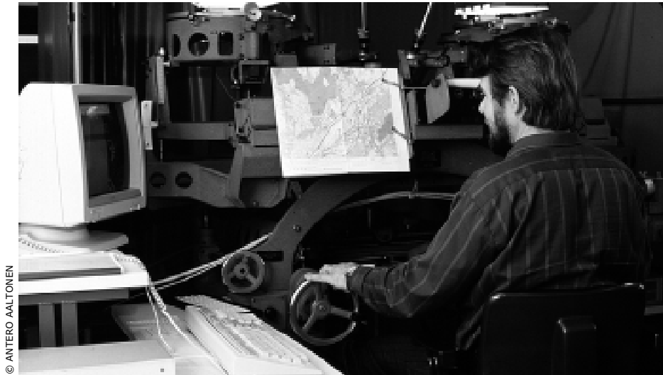
Stereokartoituskoje A8 on kuin ilma-ilmailun Douglas DC 3 (Dakota). Se siirtyy historiaan uusien ESPA-työasemien tieltä pitkän päivityön tehneenä. A8:lla on luotu lähtöaineistoa tulevaisuuden karttapoliitikkalle.
